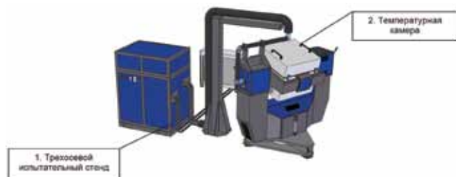
Рис. 6 Трехосевой испытательный стенд TES-6V_TM (1) производства швейцарской корпорации Acuitas GmbH, совмещенный с температурной камерой (2)
