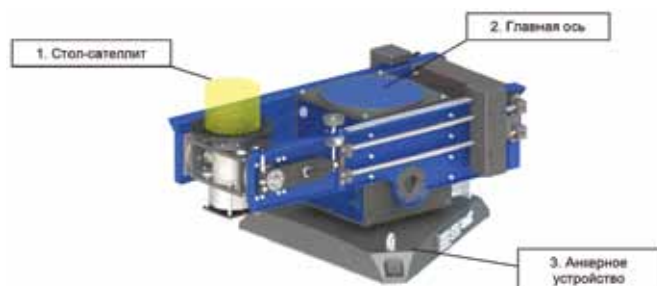
Рис. 3 Прецизионная центрифуга НРС-4С3-600 производства швейцарской компании Acuitas GmbH
