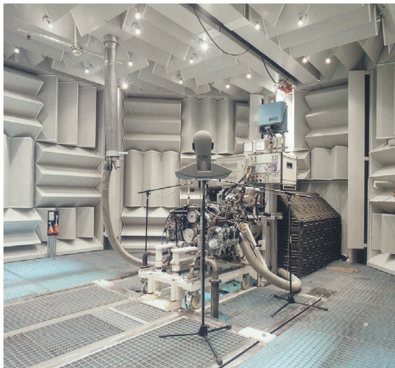
Акустическая безэховая камера IAC Acoustics для измерений двигателя Porsche
