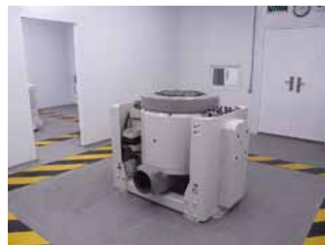
Актюатор, размещенный на виброизолированном фундаменте
