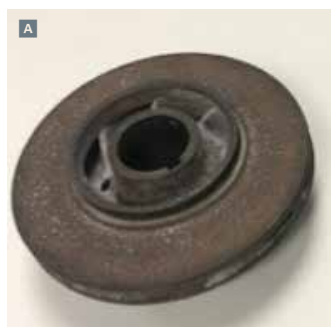
15 Оригинальный изношенный импеллер насоса системы пожаротушения атомной электростанции в Кршко, Словения A ; напечатанный импеллер B . Источник: Siemens
