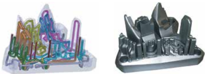
7 Модель и напечатанная вставка в форму с каналами охлаждения. Источник: Renishaw
