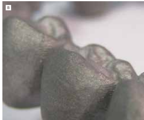
13 Внутриротовой лазерный сканер А, зубная коронка, напечатанная из сплава кобальт-хром В; покрытая керамикой коронка в разрезе С. Источник: Renishaw, CBC Dental Lab, iTero
