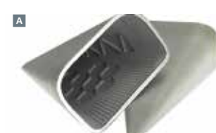
15 Оригинальный изношенный импеллер насоса системы пожаротушения атомной электростанции в Кршко, Словения A ; напечатанный импеллер B . Источник: Siemens
