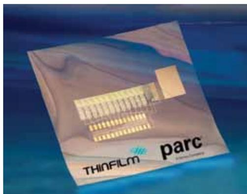
Рис. 14 Печатная память и схема адресации. Источник: Thinfilm и PARC
