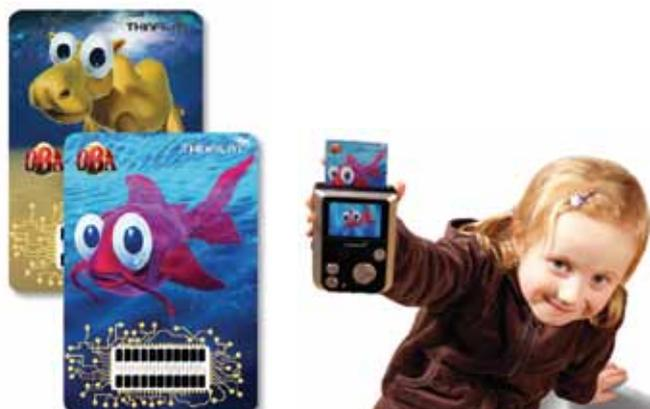
Рис. 5 Игровые карточки с печатной перезаписываемой энергонезависимой памятью (а), игровое устройство, которое может считывать и записывать данные в печатную память на карточке (б). Объем памяти карточки – 20 бит. Источник: Thinfilm
