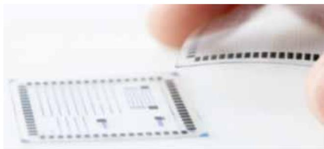
Рис. 6 Печатная перезаписываемая энергонезависимая память. Источник: Thinfilm
