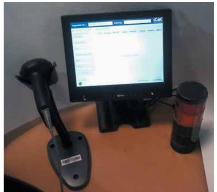
10 Рабочее место проверки комплектации линии сырьём
