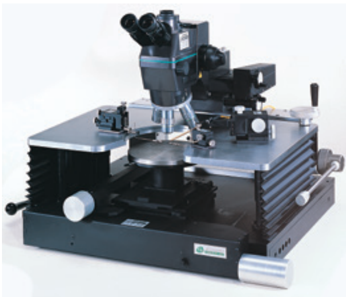
1 Ручная зондовая станция BD-8 компании EverBeing с возможностью проведения СВЧ- и DC-измерений
