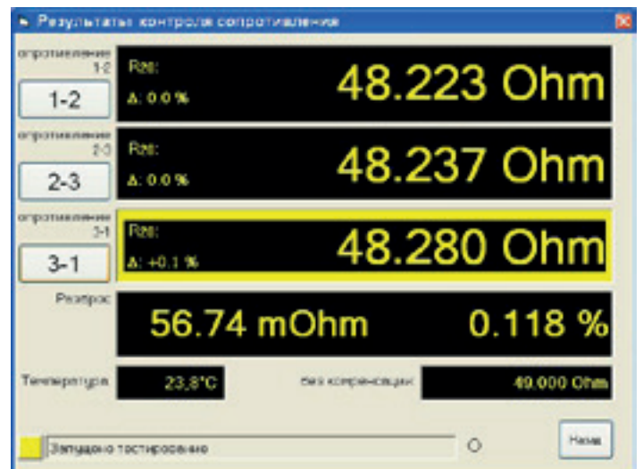
Программное обеспечение тестера Schleich MTC2. Ручной режим тестирования: выбор схемы включения фаз и номинального напряжения
