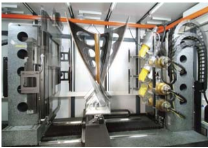
РИС. 7. ДЛЯ ПРОВЕДЕНИЯ ИНСПЕКЦИИ ОБРАЗЦОВ БОЛЬШОГО РАЗМЕРА, СИСТЕМА PHOENIXRAY V|TOME|X L 450 ИМЕЕТ ВОЗМОЖНОСТЬ ОДНОВРЕМЕННОГО ПЕРЕМЕЩЕНИЯ РЕНТГЕНОВСКОЙ ТРУБКИ И ДЕТЕКТОРА ПО ВЫСОТЕ. «СШИВКА» ЧАСТЕЙ ОБЪЕМНОГО ИЗОБРАЖЕНИЯ ПРОИЗВОДИТСЯ СРЕДСТВАМИ ПО.
