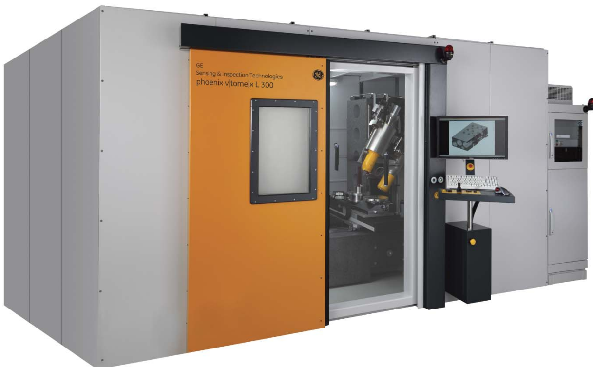
РИС. 6. БЛАГОДАРИ НОВЕЙШЕЙ МИКРОФОКУСНОЙ РЕНТГЕНОВСКОЙ ТРУБКЕ, СИСТЕМА РНОЕНИХ|RAY VITOME|X L 300 ОСОБЕННО ПОДХОДИТ ДЛЯ СКАНИРОВАНИЯ ДЕТАЛЕЙ С ВЫСОКИМ УВЕЛИЧЕНИЕМ. МОЩНОСТЬ ТРУБКИ ПОЗВОЛЯЕТ ПРОВОДИТЬ ИНСПЕКЦИЮ ДЕТАЛЕЙ ИЗ МАТЕРИАЛОВ, ХАРАКТЕРИЗУЮЩИХСЯ СИЛЬНЫМ ПОГЛОЩЕНИЕМ ИЗЛУЧЕНИЯ.
