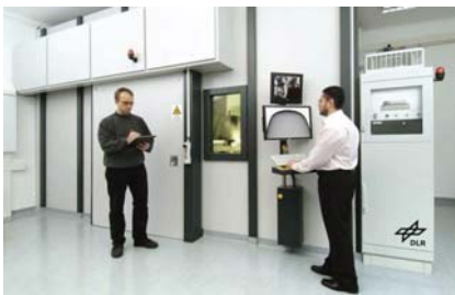
РИС. 8. ШИРОКАЯ ДВЕРЬ В ЗАЩИТНОМ КАБИНЕТЕ УСТАНОВКИ V|TOME|X L 450 ПРЕДНАЗНАЧЕНА ДЛЯ ИСПОЛЬЗОВАНИЯ СРЕДСТВ МЕХАНИЗАЦИИ ПРИ РАБОТЕ С ОБРАЗЦАМИ БОЛЬШОГО РАЗМЕРА И ВЕСА.
