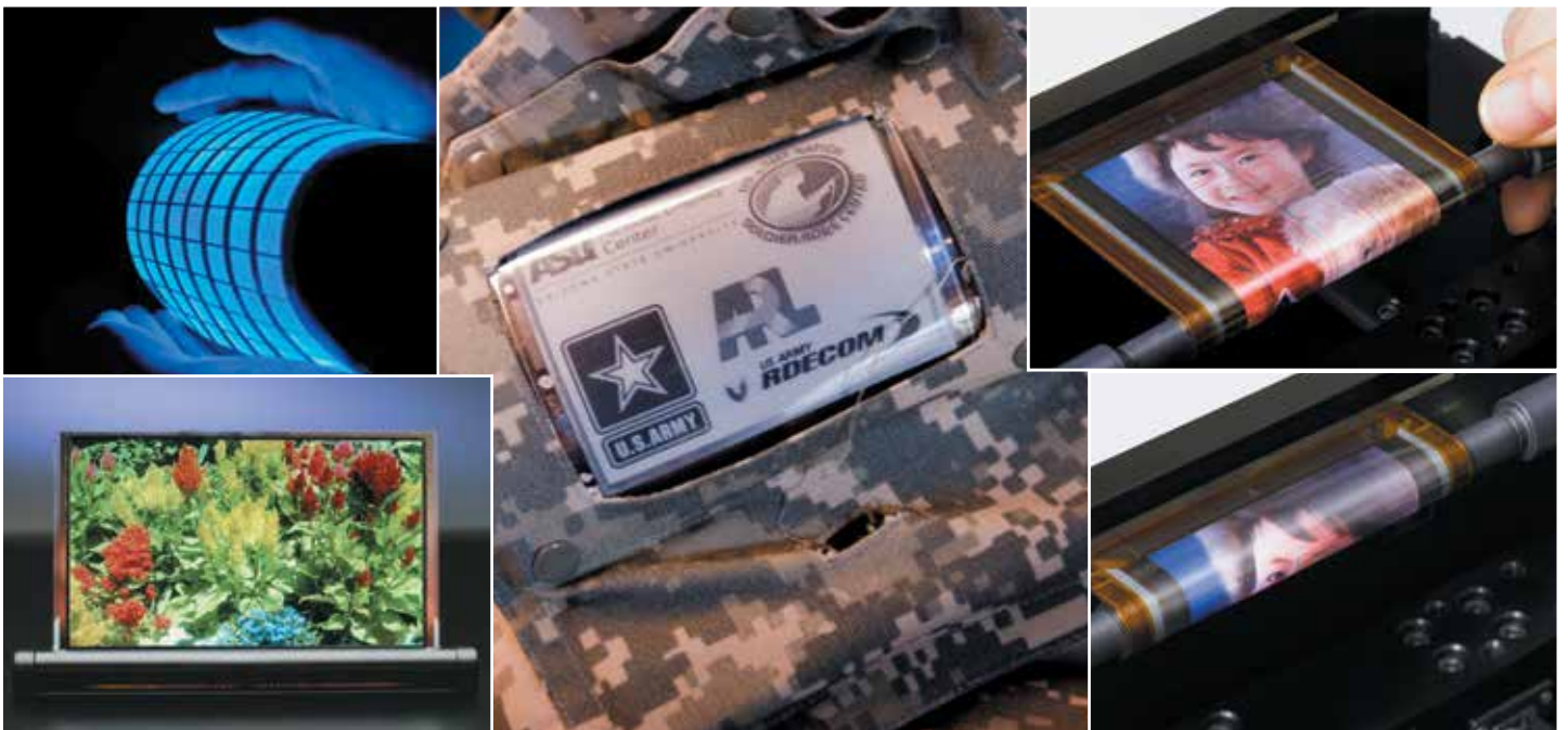
18 Примеры изделий с гибкими OLED: а - OLED, изготовленный на линии Roll-to-roll, б - OLED-дисплей фирмы Dupont, в - гибкий OLED, вшитый в нарукавник, г - гибкий экран Sony OLED
