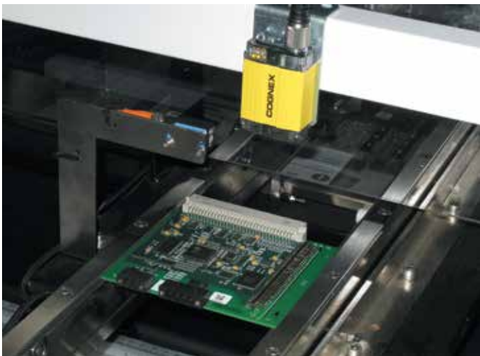
9 Считывание маркировочной метки с печатной платы на конвейере
