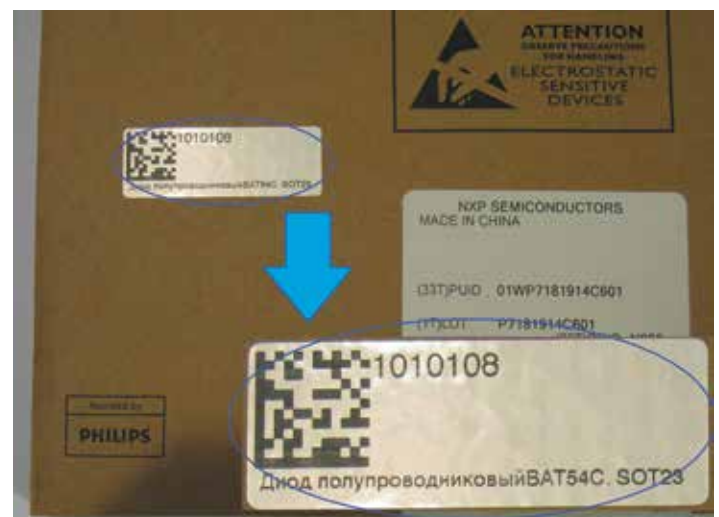
7 Пример маркировки компонентов
