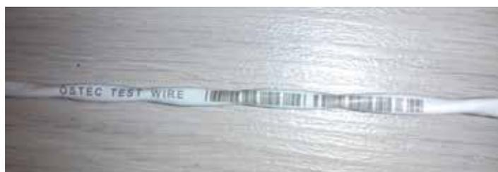
8 Лазерная маркировка проводов
