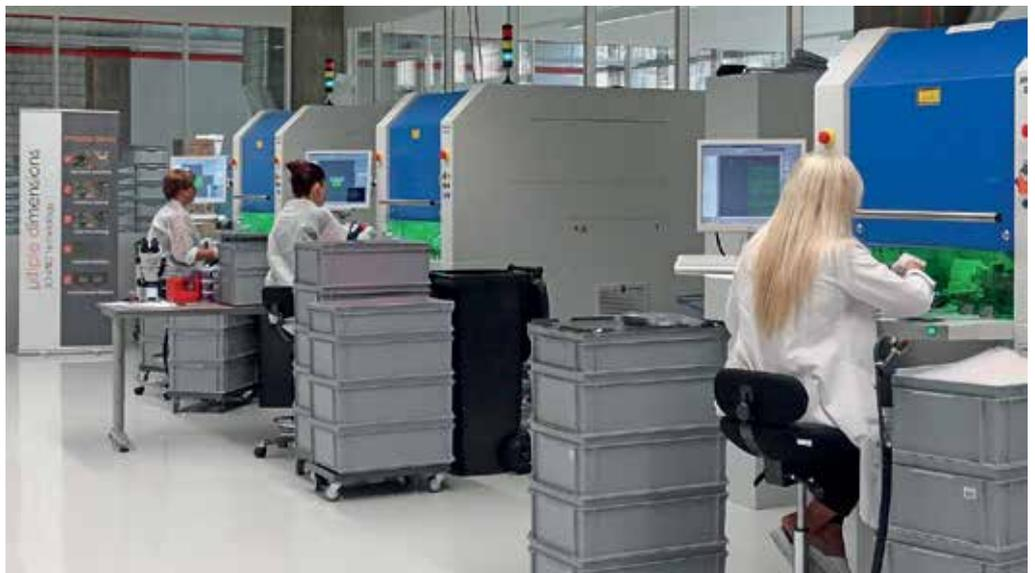
Установки прямого лазерного структурирования – теперь их целая линия
