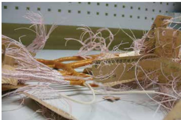
3 Жгутовые заготовки, промаркированные картонными бирками
