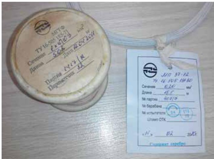
1 Проводные заготовки, промаркированные бумажными бирками заводом-изготовителем
