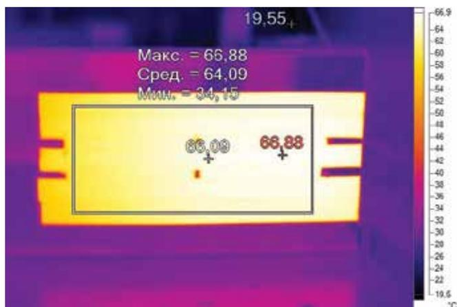
3 Процесс испытаний печатной платы на тепловой режим
