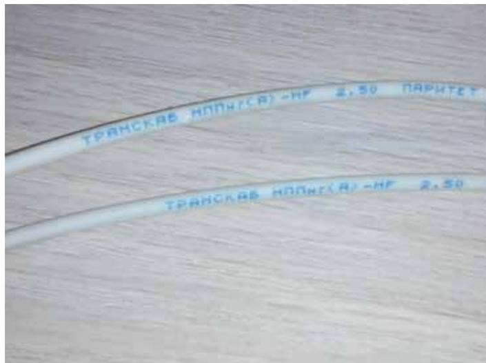
2 Маркировка проводов методом струйной печати заводом-изготовителем
