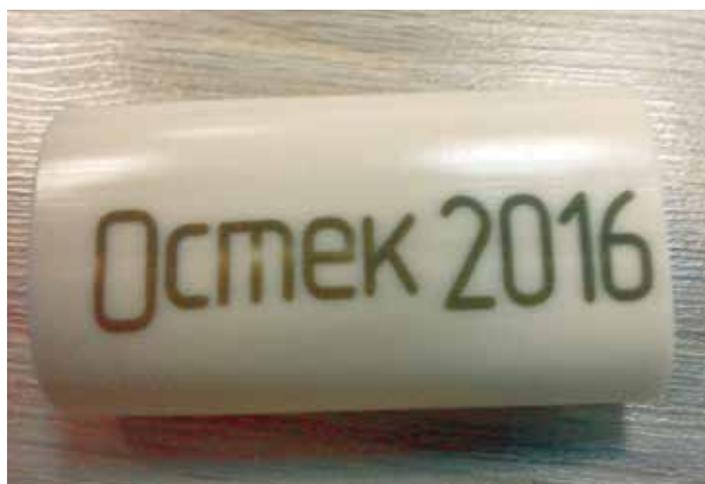
9 Лазерная гравировка ПВХ-трубки
