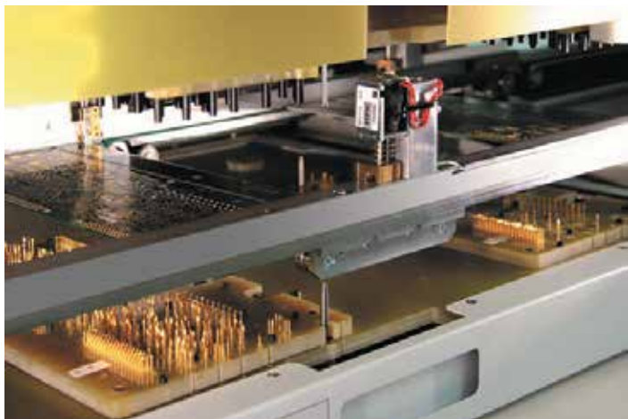
2 Контактирующее устройство тестовой системы адаптерного типа SPEA 3030
