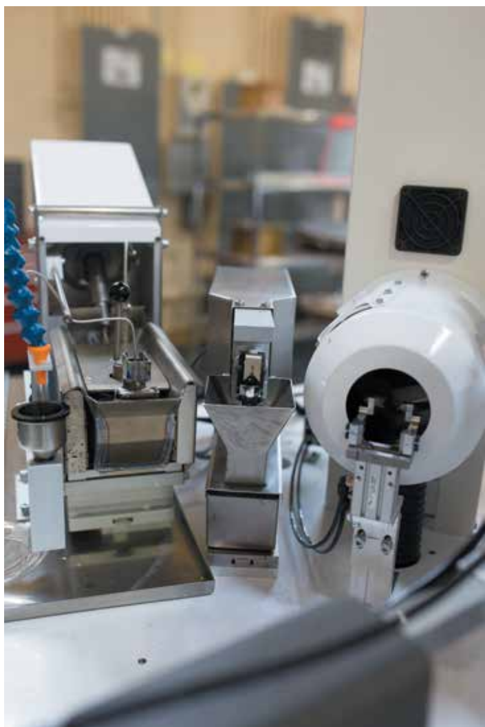
2 Модули лазерной зачистки, подкрутки жилы, флюсования и лужения в составе РКОП
