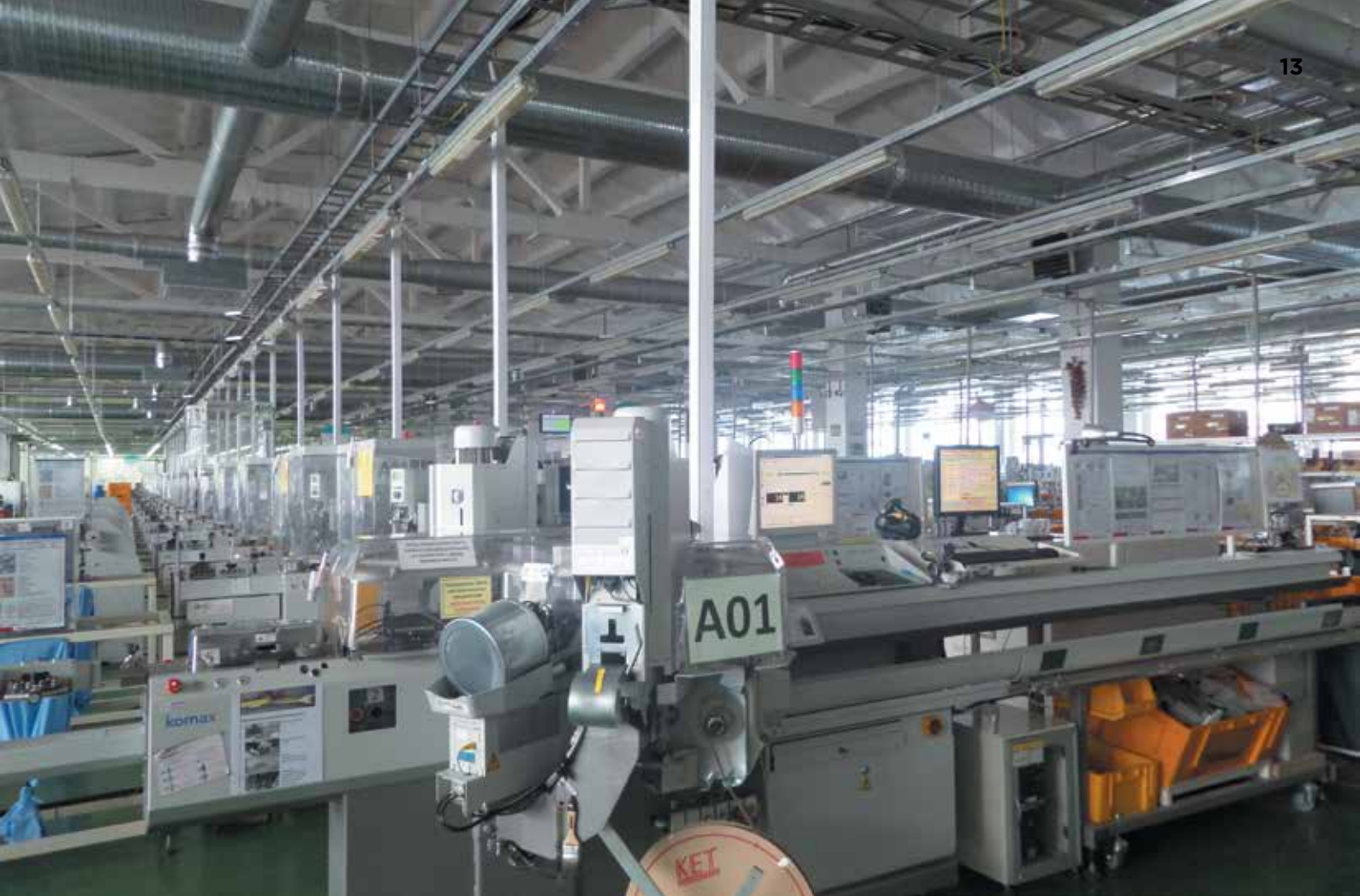
1 Автоматические линии по обработке проводов на предприятии, выпускающем жгуты для автомобильной промышленности
