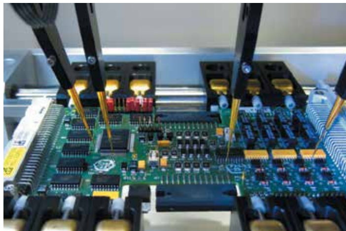
3 Контактирующее устройство тестовой системы с летающими пробниками SPEA 4060
