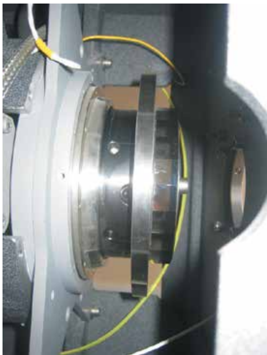
4 36-гранная призма, установленная на среднюю ось, для проведения первичной аттестации трехосевого стенда
