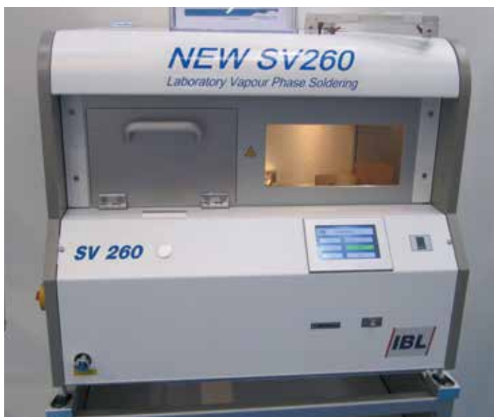
12 Лабораторная система пайки в паровой фазе SV260
