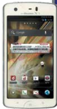
8 Смартфоны Huawei и NEC, моноблок LG, в сенсорах на экранах которых использованы прозрачные проводники из серебряных нанопроволок вместо ITO
