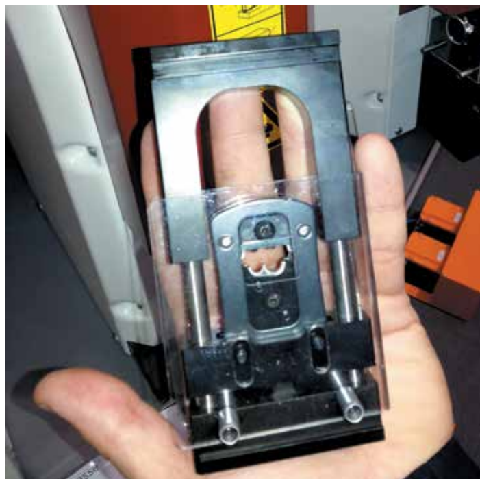
8 Сменная матрица машины опрессовки контактов WDT
