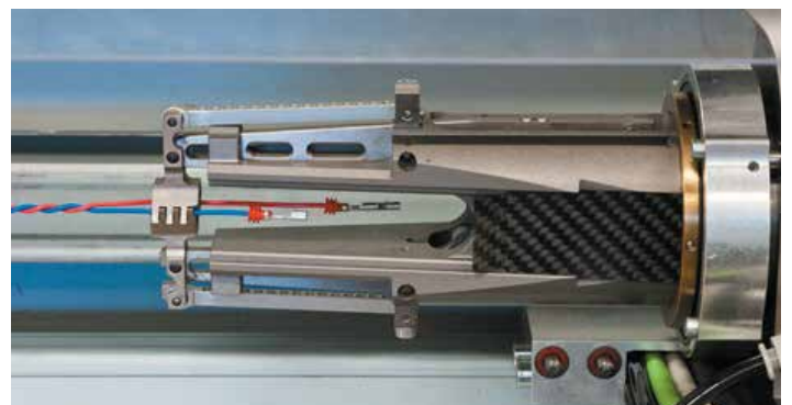
Пример обработанных проводов и витой пары, изготовленной на комплексном автомате обработки проводов Alpha 488S
