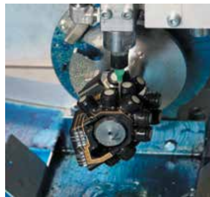
9 Сборка 3D-MID устройств на автоматической сборочной линии от компании Xepon: CAD модель устройства, модуль электрического контроля 3-х мерного основания, модуль дозирования паяльной пасты на места установки штыревых контактов, модуль автоматической оптической инспекции, модуль герметизации силиконовым компаундом, готовое устройство
