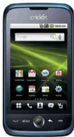
8 Смартфоны Huawei и NEC, моноблок LG, в сенсорах на экранах которых использованы прозрачные проводники из серебряных нанопроволок вместо ITO
