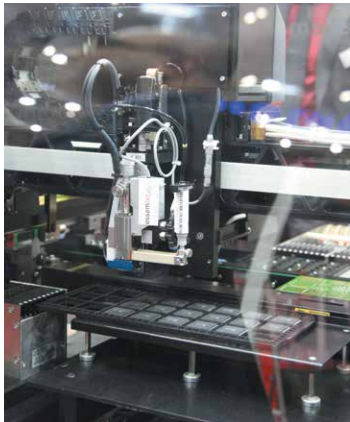
8 Каплеструйный дозатор, смонтированный на установочной голове автомата Paraquda
