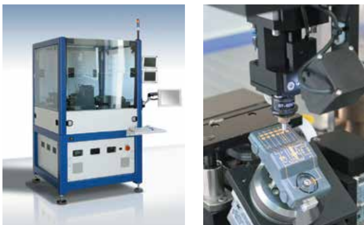
5 Базовый модуль VICO и примеры модулей расширения (позиционирование, транспортировка, нанесение и т.д.)
