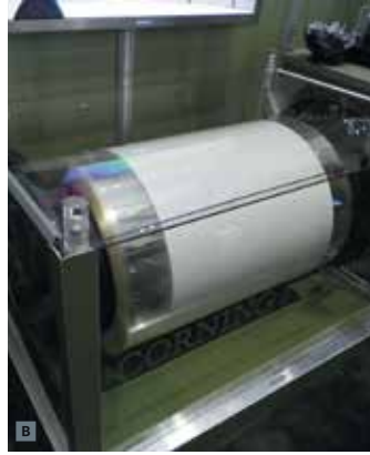
1 A демонстрация гибкости стекла, катушка, на которую намотано около 300 метров ленты из гибкого стекла шириной 1 метр. Источник: Corning
