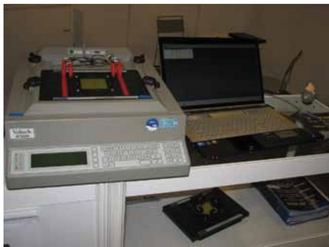
Рис. 1 Тестер моточных изделий AT3600 фирмы Volttech
