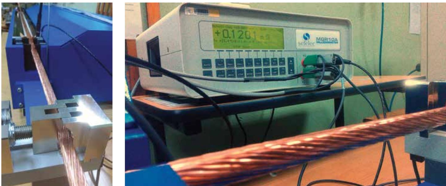
1 Фиксация кабельной жилы (слева) и микроомметр MGR10 (справа)
