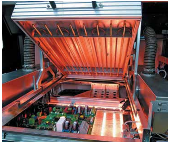
6 ИК (снизу) и конвекционный (сверху) нагрев ПУ
