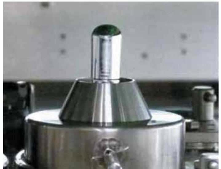
7 Смачиваемый припоем волнообразователь в азотном кольце
