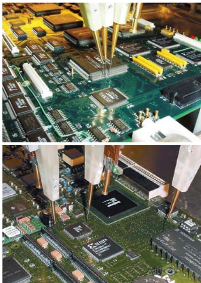
Рис. 3 Летающие пробники в работе
