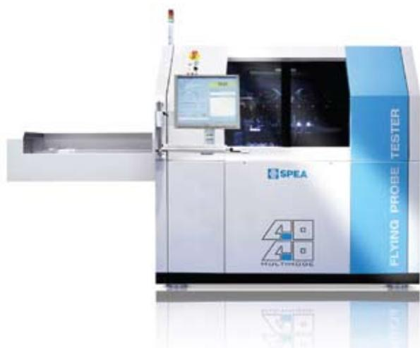
Рис. 2 Система электрического контроля с летающими пробниками
