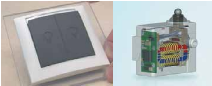
5 Беспроводной передатчик, вырабатывающий энергию от нажатия клавиши
