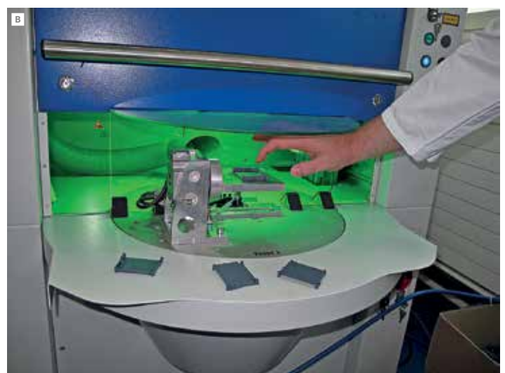
4 Машина лазерной активации Microline 3D компании LPKF А , установка заготовки в держатель на поворотном столике Б
