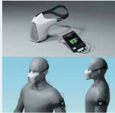
11 Турбина, работающая от дыхания человека
