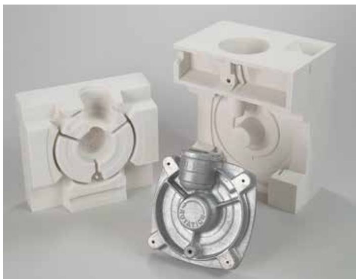
Литьевые формы, выполненные на 3D-принтере
