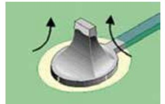
Для образования правильной формы галтели, жало паяльника должно двигаться вверх вдоль вывода элемента. *ВНИМАНИЕ.* Избегайте сильного давления жалом паяльника на КП. Не допускайте контакта жала паяльника с галтелью припоя без использования трубчатого припоя, это может привести к деградации паяного соединения.
