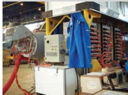
Рис. 3 Вид авиационного тестового комплекса кабельных систем. Комплекс выполнен на раме контейнерного типа для удобной транспортировки
