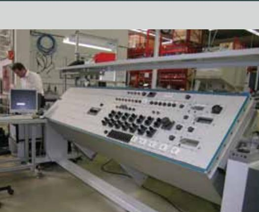
**Рис. 5** Стенд контроля жгутовых соединений энергетических агрегатов
