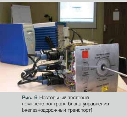
**Рис. 6** Настольный тестовый комплекс контроля блока управления (железнодорожный транспорт)
