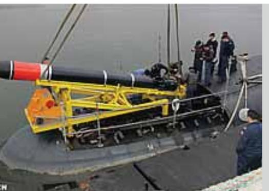
**Рис. 7** Мобильный тестовый комплекс для контроля изделий спецтехники (проверка цепей безопасности перед загрузкой торпеды на ПЛ)
