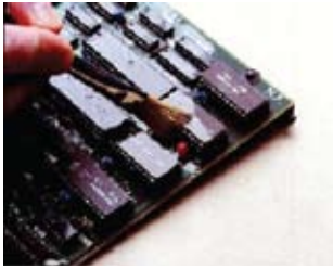
Рис. 2 Нанесение влагозащитного покрытия кистью
