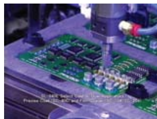
Рис. 12 Прецизионное нанесение покрытия в труднодоступные места с помощью автомата Asymtek
