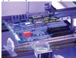
Рис. 11 Пленочное нанесение влагозащитного покрытия автоматом Asymtek SL-940E и аппликатором SC-204
