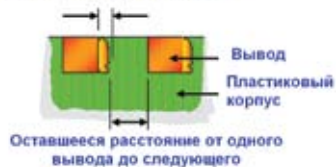
Рис. 7 «Смазывание» материала металлических выводов при резке и возникновение заусенцев
