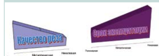
Рис. 2 Общая зависимость качества реза и срока эксплуатации диска от материала связки
