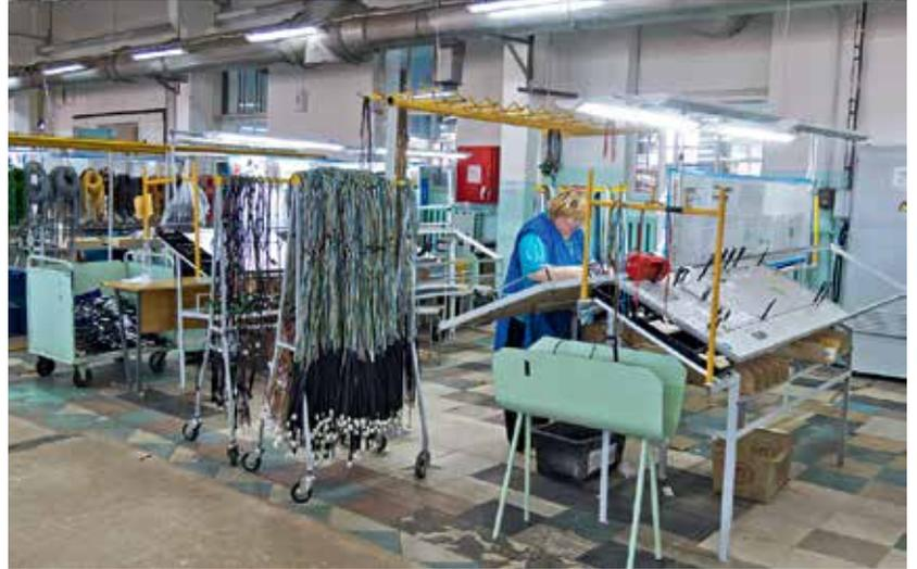
Полуавтомат Cosmic 48R компании Komax для зачистки тонких коаксиальных проводов (слева). Участок финишной сборки автомобильных жгутов (справа)
