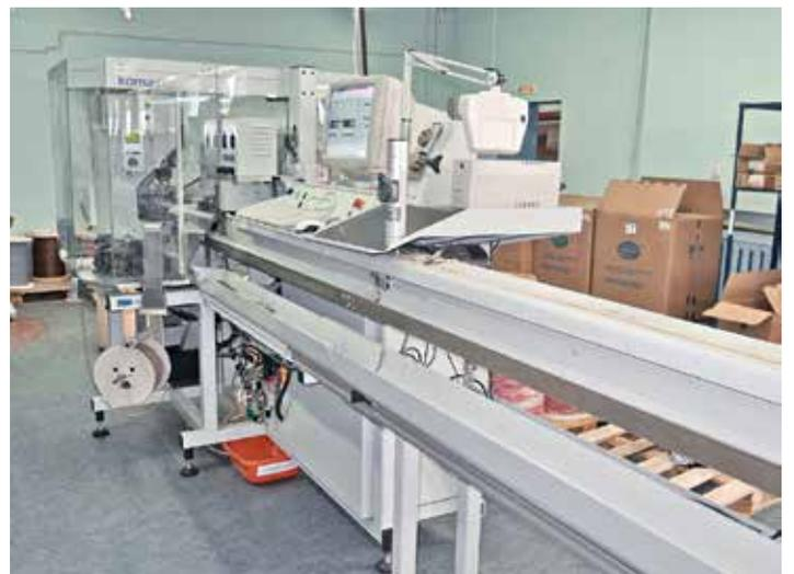
Участок жгутов для бытовой техники (слева). Автоматическая линия Komaх Gamma 333 PC-B (справа)
