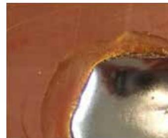
3 Пайка трубчатыми припоями с флюсом на основе канифоли RO (слева) и синтетической смолы RE (справа)
