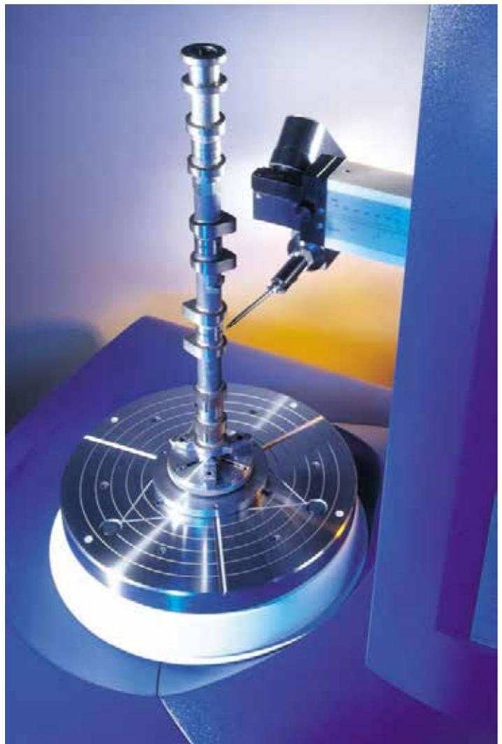
**4** Измерение распределительного вала на кругломере
