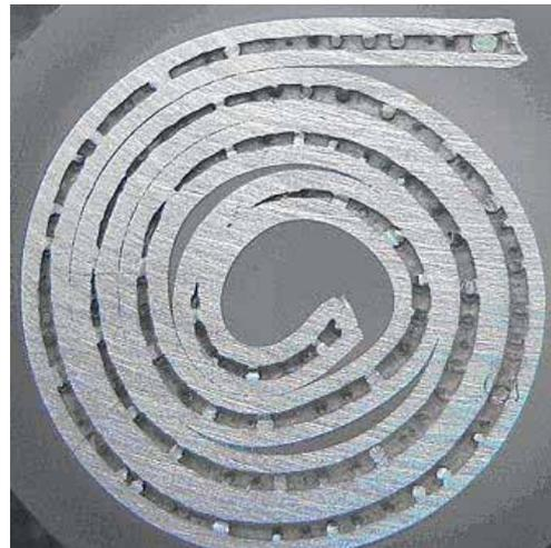
**6** Микрошлиф трубчатого припоя с частичным пропуском флюса
