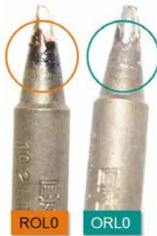
4 Сокращение темных остатков флюса на жале паяльника на примере пайки трубчатым припоем с флюсом на органической основе ORLO, 2 г трубчатого припоя, 380 °С
