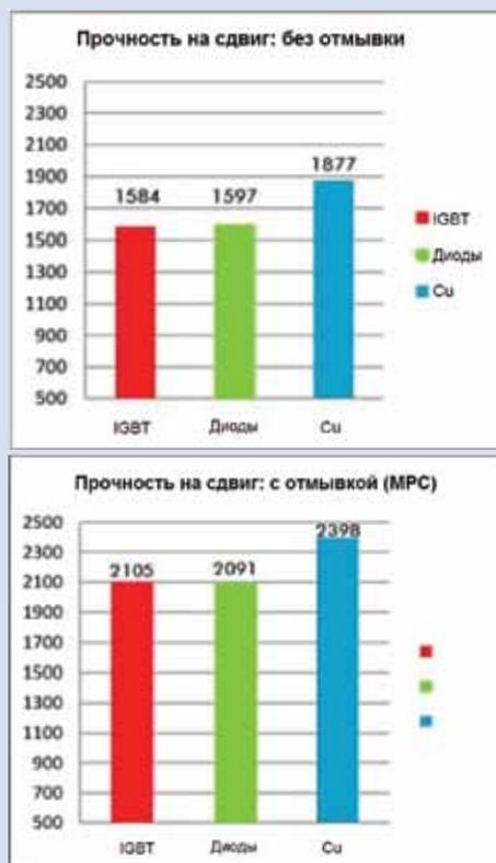
Рис. 4 Прочность микросварного соединения на сдвиг: без отмычки (сверху); с отмывочной жидкостью Vigon PM105 перед микросваркой (снизу)
