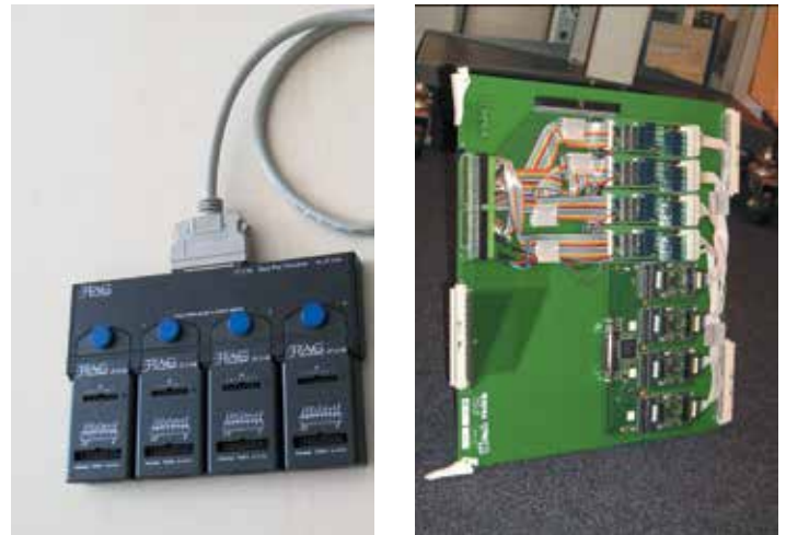
3 Трансивер QuadPOD. а) Настольный вариант исполнения; б) В форм-факторе инструментальной карты для SPEA 3030
