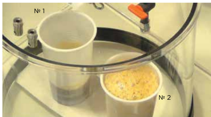
1 Процесс вакуумизации образцов ВК-9, полученных на оборудовании Dorag Eldomix (№ 1) и вручную (№ 2) Образец № 1 — клей ВК-9. Приготовлен на оборудовании Dorag Eldomix с предварительной дегазацией компонентов в баках системы. Образец № 2 — клей ВК-9. Приготовлен ручным перемешиванием компонентов, взятых непосредственно из заводской упаковки.
