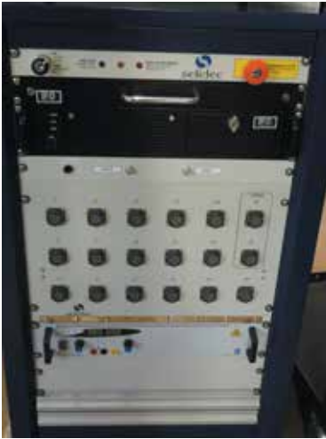
4 Пример оснастки — интерфейс под разъемы заказчика
