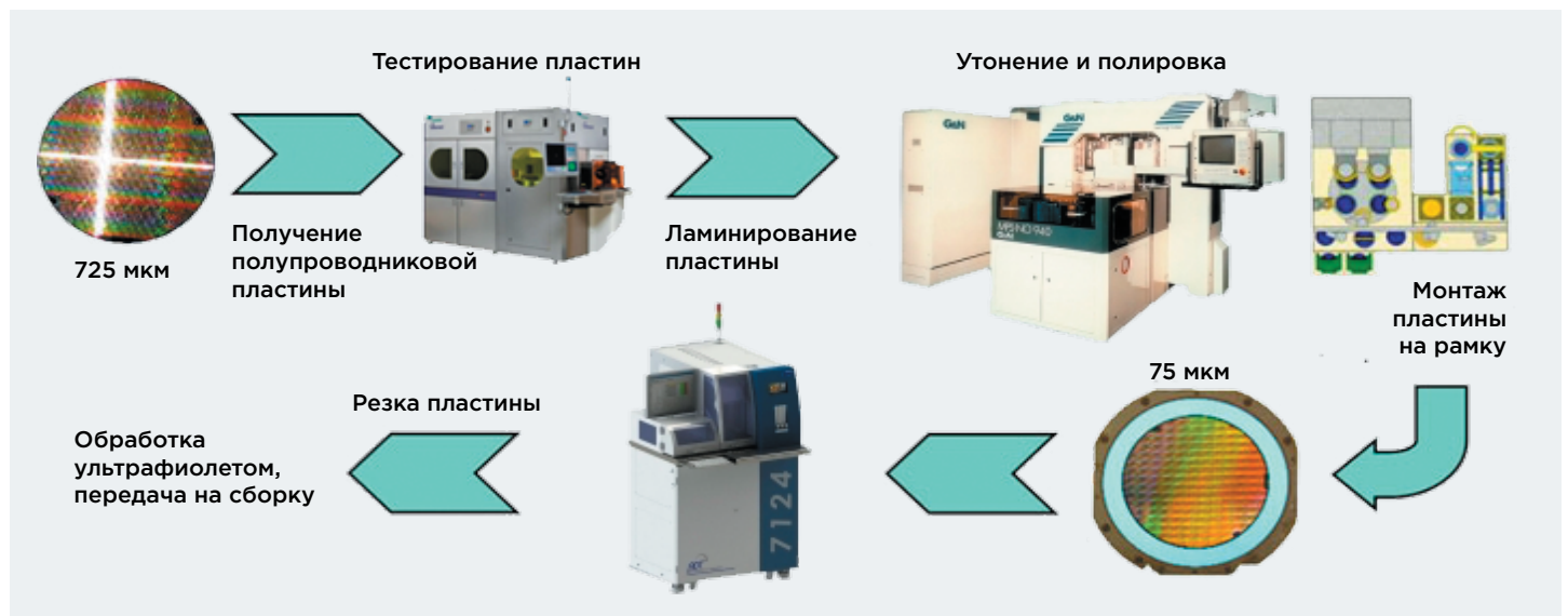
Процесс обработки тонких пластин от тестирования до разделения на чипы
