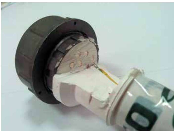
8 Внутренняя инспекция качества герметизации разъема
