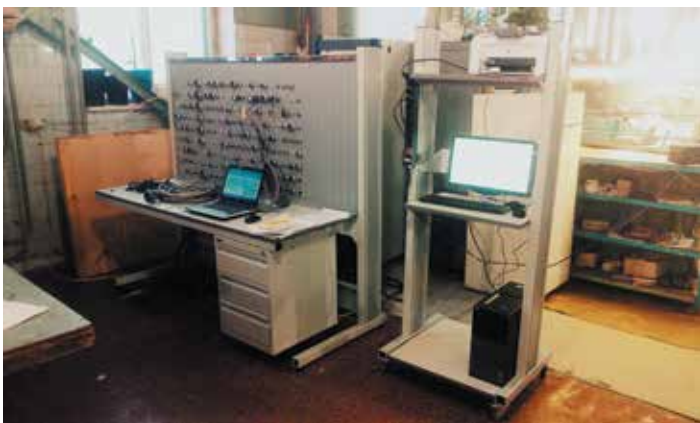
8 Вариант оснастки — рабочее место контроля жгутов
