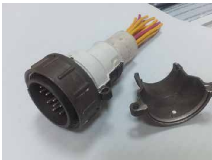
7 Поверхностная инспекция качества герметизации разъема
