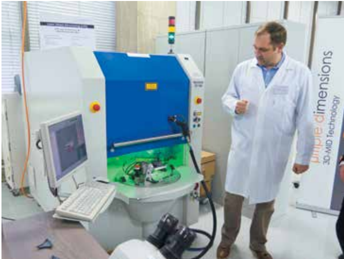
Участок лазерного структурирования. Установка Microline 3D 160i компании LKPF выглядит в просторном цеху как точка роста будущего массового производства
