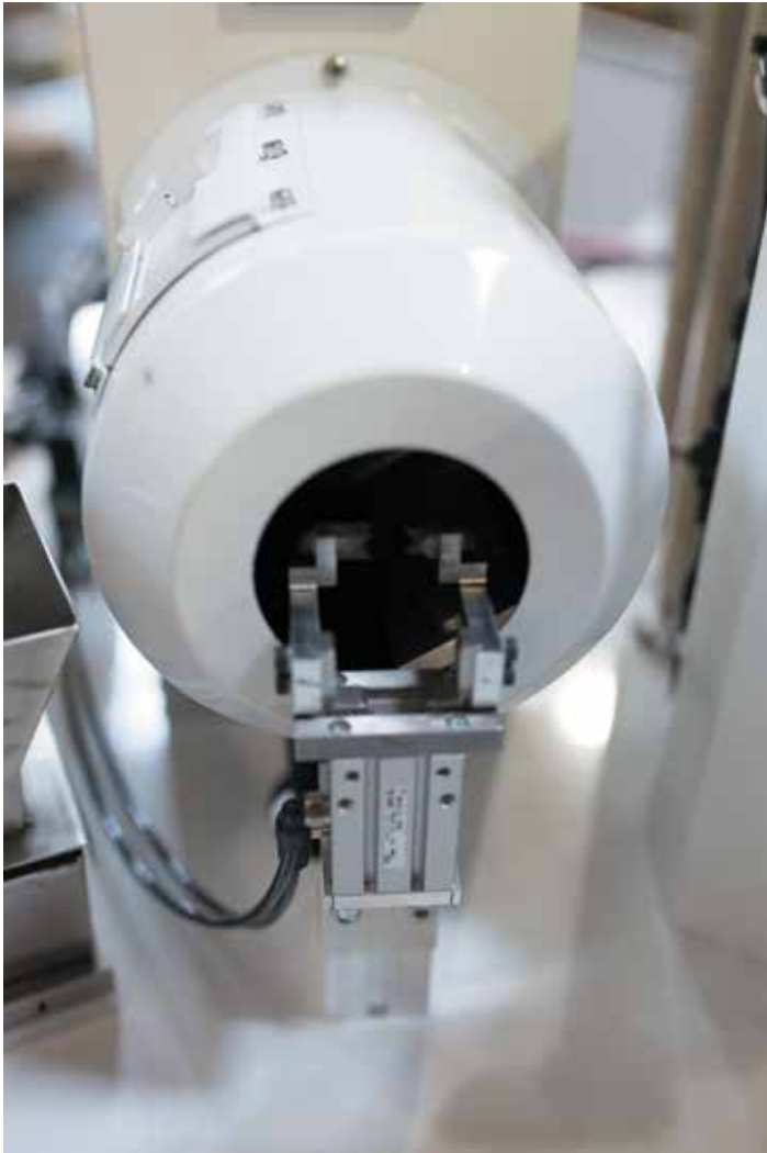
3 Модуль лазерной зачистки проводов в РКОП
