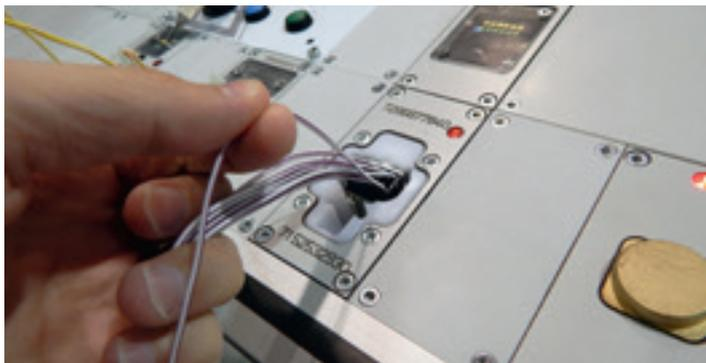
7 Терминал установки наконечников
