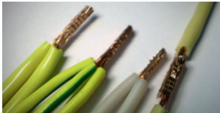
8 Сварка проводов ультразвуковым методом
