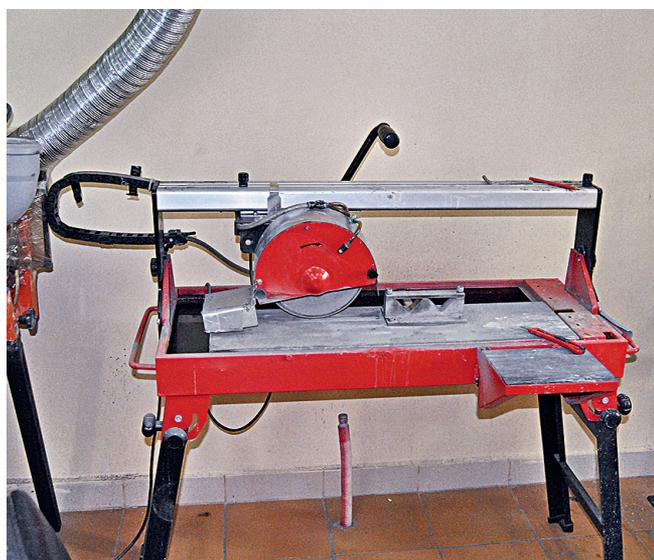
Установка для распиливания керна на образцы
