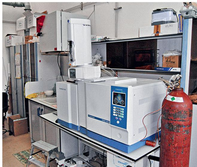
*Газовый хромато-масс-спектрометр YL 6900 GC / MS*
