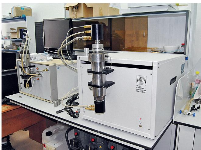
Установка определения пористости и проницаемости – порозиметр AP-608
