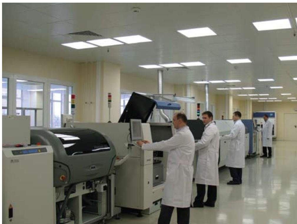
Рис. 6 Новая автоматизированная линия поверхностного монтажа
