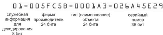
Рис. 5 Пример 96-битной кодировки объекта. Источник: Guidelines for Securing Radio Frequency Identification (RFID) Systems. Recommendations of the National Institute of Standards and Technology
