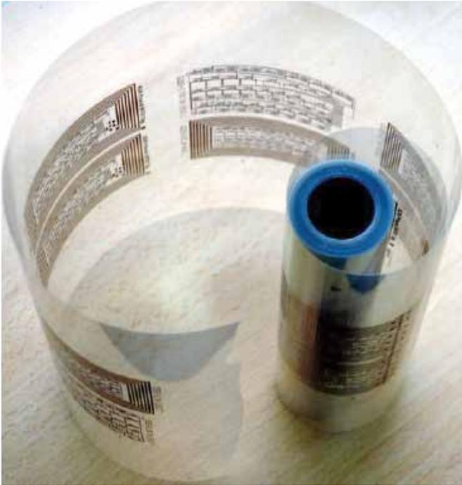
Рис. 12 Метка, изготовленная по печатной технологии. Источник: OE-A
