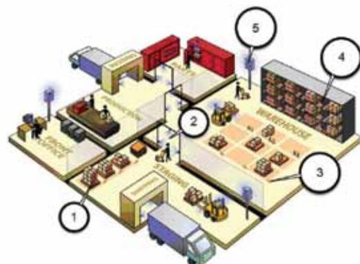
Рис. 7 Предприятие, использующее систему радиочастотной идентификации: 1 - радиочастотная метка, 2 - порталный считыватель, 3 - место назначения, 4 - место хранения, 5 - точка доступа в систему. (Front office - офис, Production - производство, Receiving - закупка, Parts - запчасти, Tools - инструменты, Warehouse - склад, Staging - подготовка или упаковка, Shipping - отгрузка)
