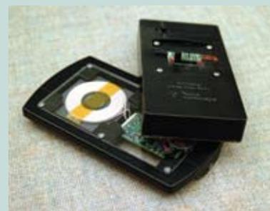
**Рис. 3** Беспроводные приемник и передатчик энергии из состава инструментария bqTESLA
