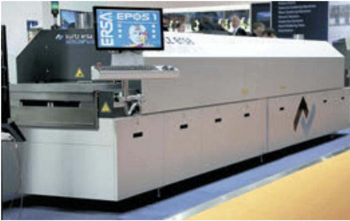
5 Конвекционная печь Hotflow 4/20 на стенде ERSA
