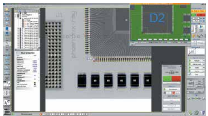
26 Пример работы стратегии для многовыводной микросхемы (красным цветом выделены пины, распознанные как дефект)
