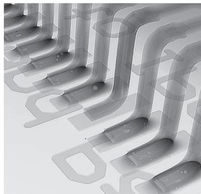
Рис. 4 Снимок, полученный на цифровом детекторе GE DXR250
