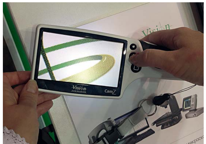
Портативная инспекционная измерительная система CamZ
