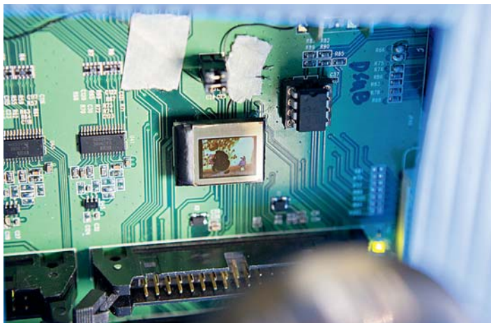
AMOLED дисплей производства ОАО «ЦНИИ «Циклон»
