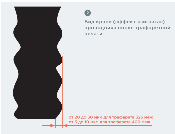
Пример печати тонких проводников
