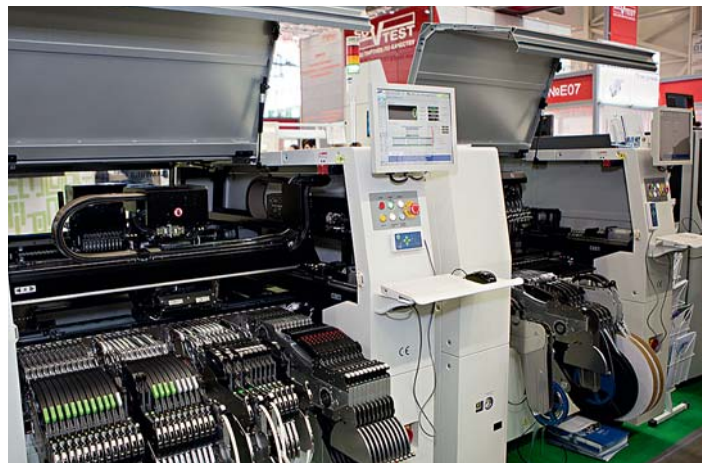
Автоматы установки компонентов Samsung серии SM
