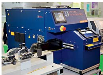
Оборудование лазерной зачистки Siena 750
