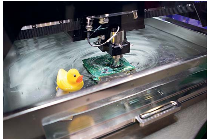
Аппарат акустической микроскопии Sonoscan
