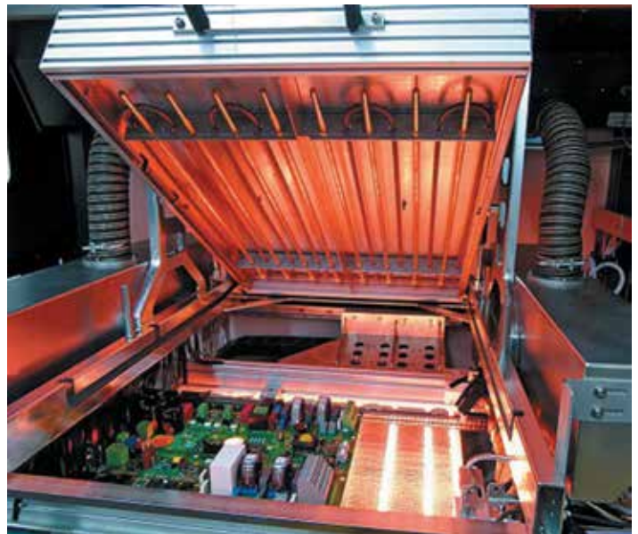
6 ИК (снизу) и конвекционный (сверху) нагрев ПУ
