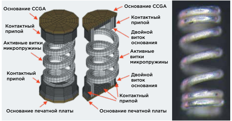
5 Типовая конструкция микропружины
