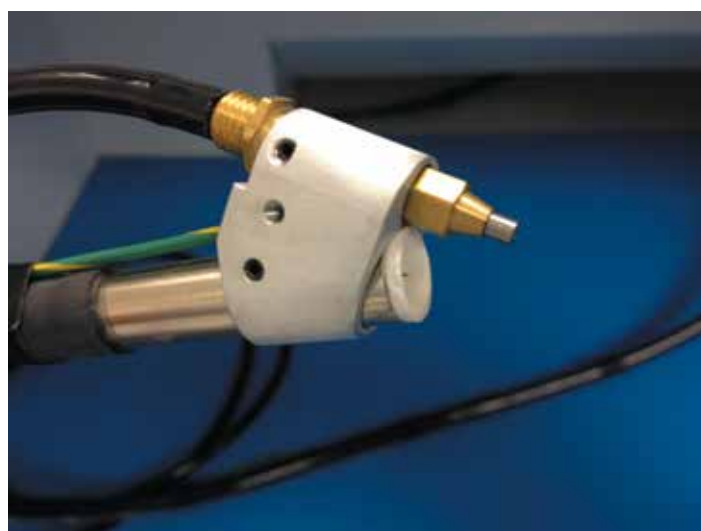
4 Блок наконечника распыления абразива с форсункой и микроионизатором
