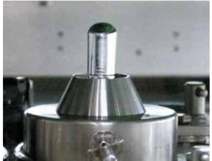
7 Смачиваемый припоем волнообразователь в азотном кольце
