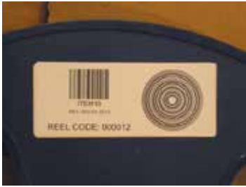
6 Пример нанесения кода на катушку для регистрации в системе хранения
