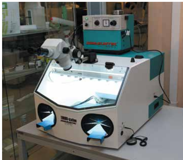
3 Установка для абразивного удаления влагозащитных покрытий Swam Blaster Turbo Max
