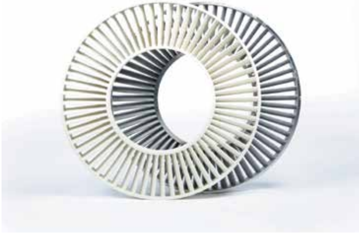
6 Пример изделия, отлитого по выплавляемым пластиковым моделям
