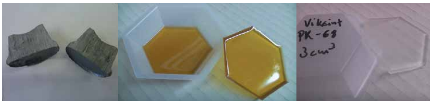
7 Образцы отверждённого материала КДС-174 с введёнными твёрдыми наполнителями, ВК-9, Виксинт ПК-68
