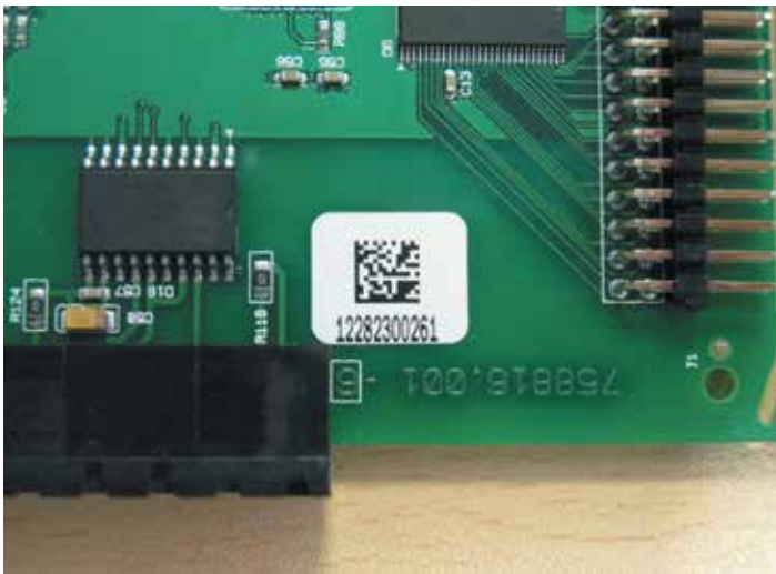
8 Пример маркировки печатной платы
