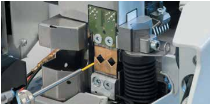
3 Модуль контроля касания жилы для автоматической линии обработки провода
