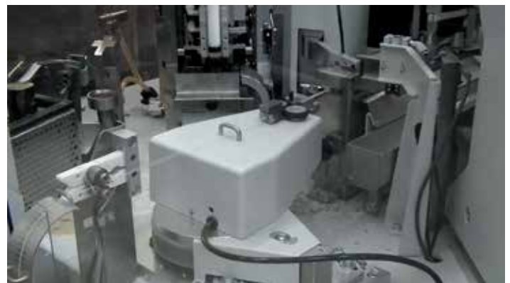
4 Автоматическая линия обработки провода с модулями лазерной зачистки, подкрутки, флюсования и лужения
