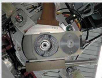
Прижимная пята для фрезерного шпинделя
