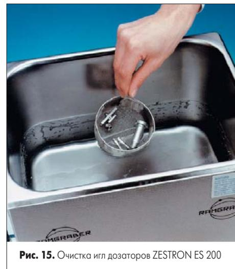
Рис. 15. Очистка игл дозаторов ZESTRON ES 200
