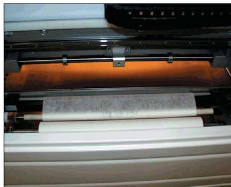
Рис. 11. Протирка трафарета в автомате трафаретной печати
