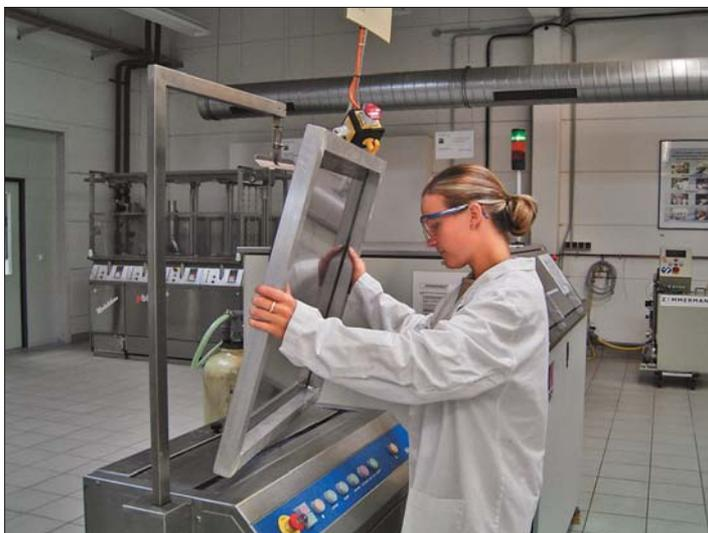
Рис. 7. Очистка трафарета в установке с применением ультразвука
