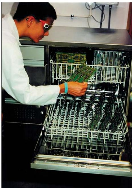
Рис. 5. Струйная отмычка распылением с применением VIGON A 200
