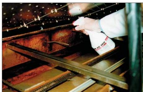
Рис. 14. Очистка печей оплавления с использованием VIGON RC 101
