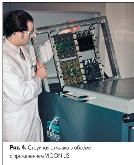
Рис. 4. Струйная отмывка в объеме с применением VIGON US
