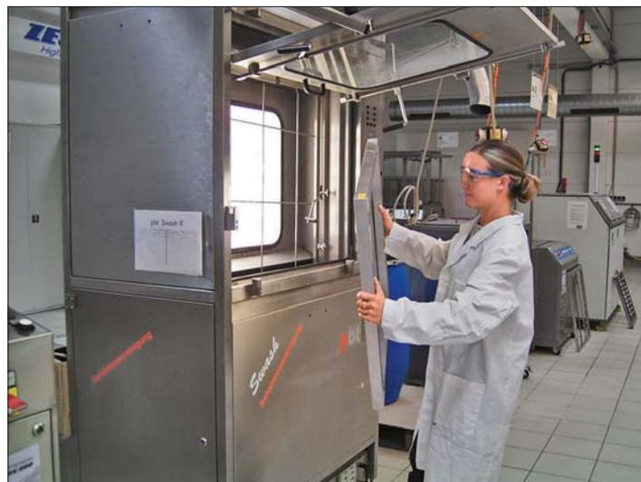
Рис. 8. Очистка трафарета в установке струйной отмывки
