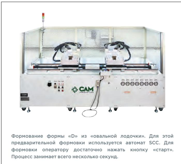
Формование формы «D» из «овальной лодочки». Для этой предварительной формовки используется автомат SCC. Для формовки оператору достаточно нажать кнопку «старт». Процесс занимает всего несколько секунд.
