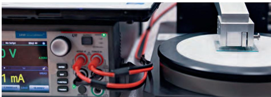
В комплект ИУС-7 входит четырехзондовая измерительная голова, параметры которой подбирают в зависимости от исследуемого материала, а также ПО «Кристалл» для автоматического расчета удельного и поверхностного сопротивления с учетом размеров образцов согласно стандарту ASTM F84-99. Разработанное ООО «Остек-Электро» программное обеспечение может быть легко модернизировано под технические требования заказчика.
