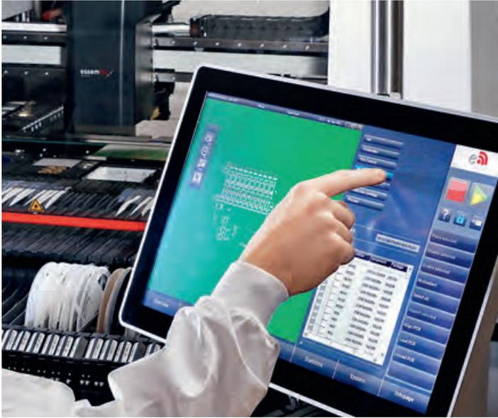
Essemtec Fox: настройка дозирования материалов и установки компонентов осуществляется при помощи единого программного обеспечения
