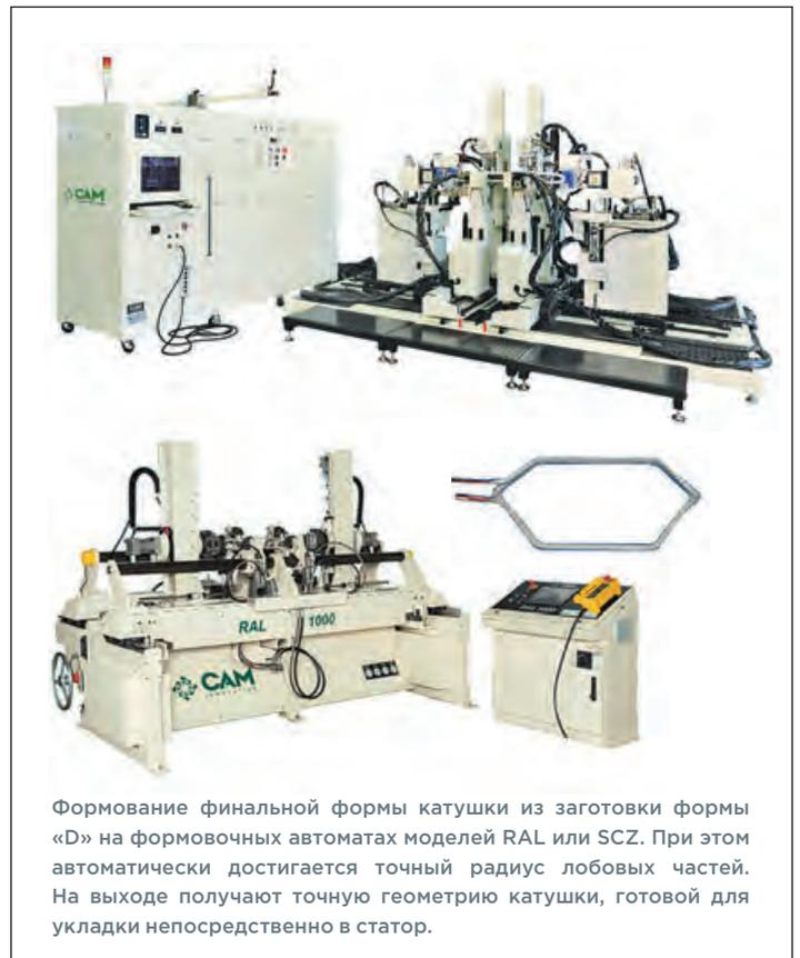
Формование финальной формы катушки из заготовки формы «D» на формовочных автоматах моделей RAL или SCZ. При этом автоматически достигается точный радиус лобовых частей. На выходе получают точную геометрию катушки, готовой для укладки непосредственно в статор.
