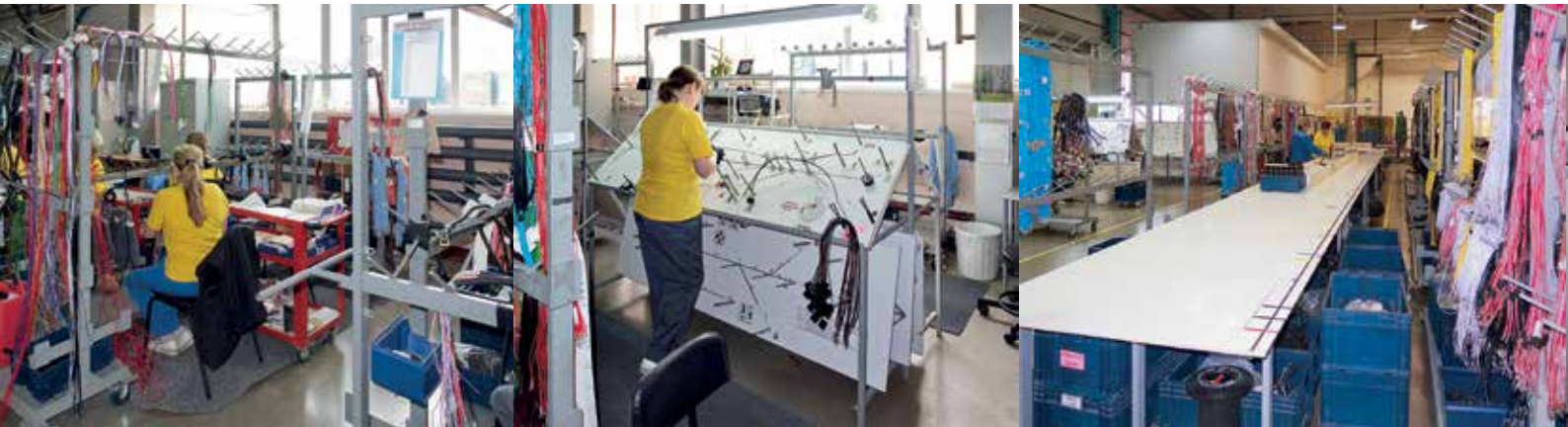
Участок вязки дополнительных жгутов (справа - стол для монтажа длинных жгутов)
