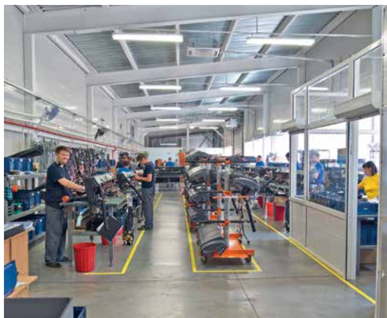
Сборка приборных панелей
