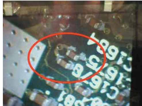
5 Боковое смещение компонентов после установки
