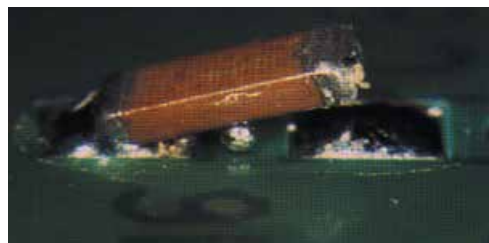
1 Фотографии дефекта «надгробный камень»
