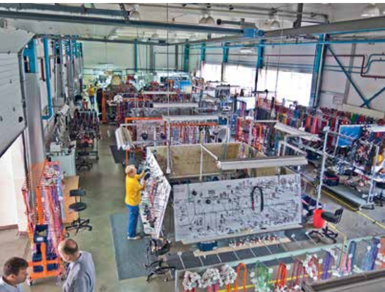
Цех монтажа жгутов
