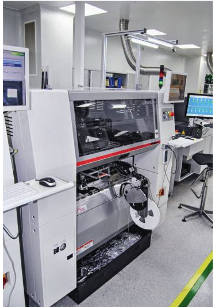
Одно из последних приобретений предприятия – автомат установки компонентов Hanwha SM482 Plus
