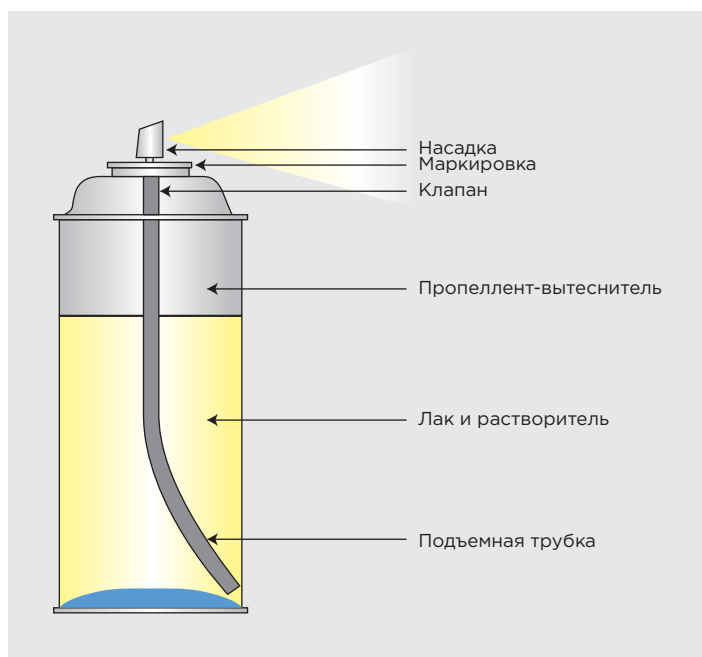
Конструкция аэрозольного баллона
