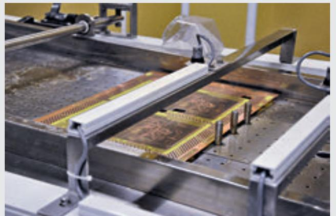
Плата в зоне охлаждения приемного стола линии Post-HASL. После снижения температуры до заданного значения пальцы, препятствующие движению платы, будут автоматически убраны, и воздушная подушка перенесет плату в зону отмывки
