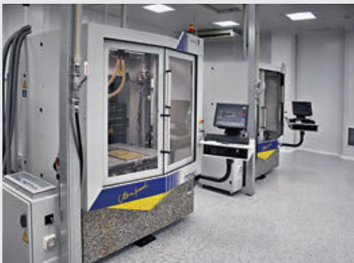
Высокоскоростной двухшпиндельный сверлильно-фрезерный станок Ultraspeed Mono Combi компании Posalux (Швейцария) (слева); установка трафаретной печати компании GILCO (справа)
