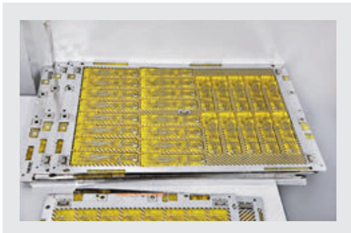
На этой мультизаготовке пять тестовых купонов: четыре по углам и еще один посередине; их можно различить по наличию пары базовых отверстий сравнительно большого диаметра
