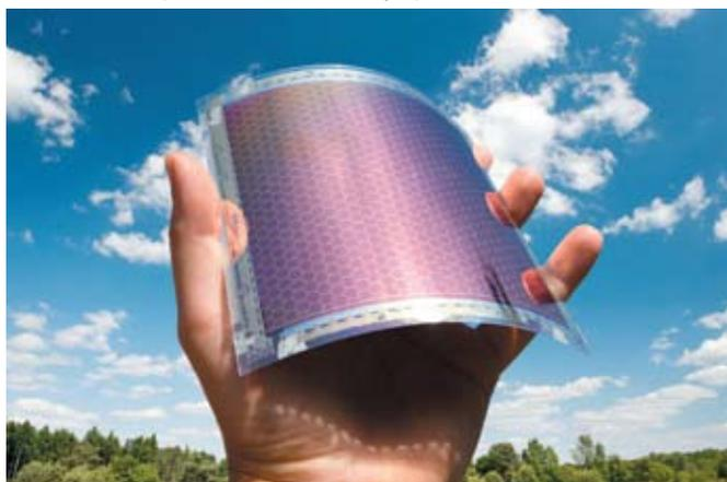
Рис. 2 Органическая фотоэлектрическая ячейка общей площадью  $15 \times 15 \text{ см}^2$  (активная область  $144 \text{ см}^2$ ). Устройство не содержит оксида индия и олова. Прозрачный электрод и фоточувствительный слой напечатаны из полимерных растворов, металлическая решетка также напечатана из раствора
