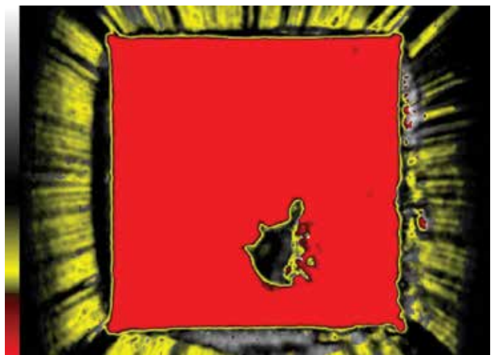
3 Акустическое изображение компонента в пластиковом корпусе типа BGA, которое позволило выявить отслоение компаунда от кристалла. Наблюдается небольшая темная аномальная область
