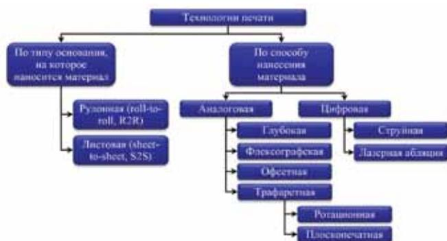
Рис. 12 Классификация основных технологий печати, которые могут быть использованы для производства электроники
