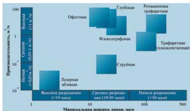
Рис. 13 Производительность и минимальная ширина линии основных технологий печати. Источник: OE-A
