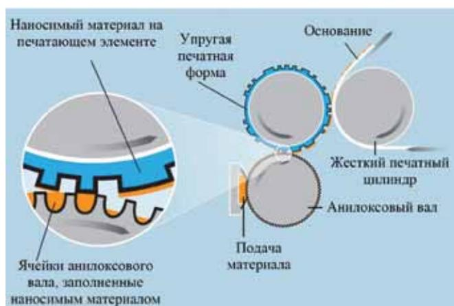
Рис. 15 Схематическое изображение процесса флексографской печати. Источник: OE-A
