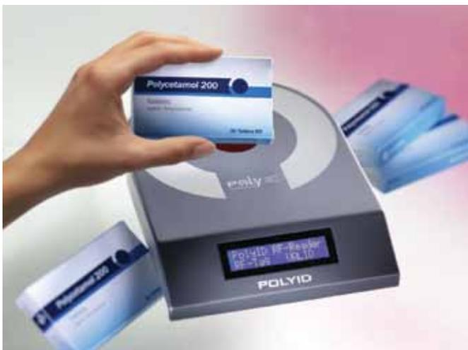
Рис. 5 Прототип «защиты бренда»: на упаковке с таблетками напечатана RFID-метка, позволяющая при поднесении к сканеру определить подлинность таблеток. Источник: PolyIC
