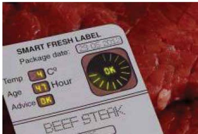
Рис. 8 Прототип «индикатора свежести» продукта – пример «умного объекта». Источник: Holst Centre
