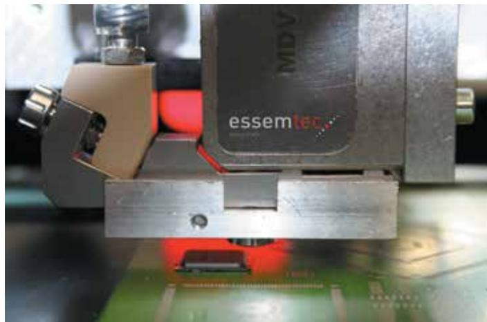
В отличие от других автоматов установки компонентов, где может быть дополнительно реализовано только дозирование при помощи пневматической или шнековой головки, в этой модели может использоваться специальная головка для высокоскоростного и прецизионного бесконтактного каплеструйного нанесения материалов, таких как паста или клей.
