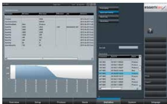
каждого установленного или отбракованного компонента, а также контроль остатка компонентов на складе для своевременного пополнения. Программное обеспечение ePlace может работать в сочетании с другими модулями, в частности eMis, в которых реализуется полная прослеживаемость, мониторинг работы и управление складом.
