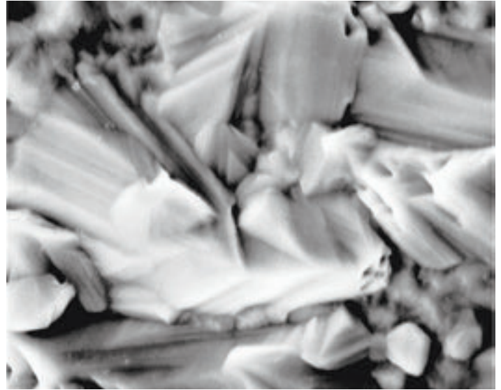
8 Покрытие иммерсионного олова на медь (большие плотноупакованные кристаллы)
