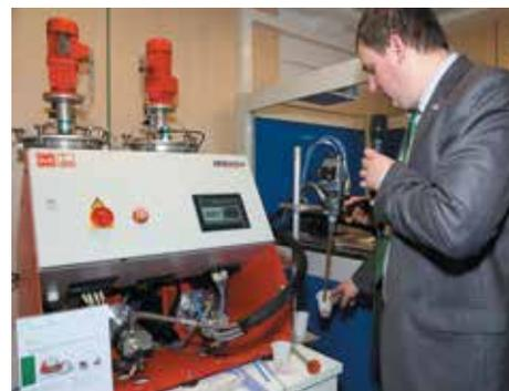
и дозирования отечественных материалов на примерах материалов ВК-9 (Dorag Eldomix 103) и Виксинт У-2-28 (Dorag Metamix), вакуумная заливка изделий и система координатного нанесения материала (DowCorning 744) на базе робота-манипулятора Fisnar F9800N.
