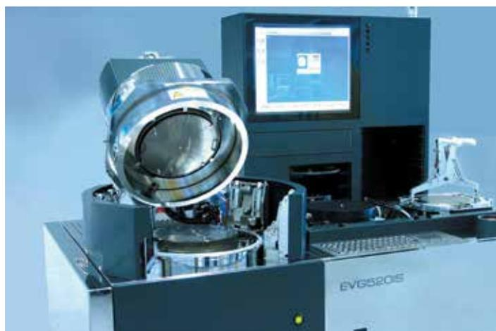
1 Полуавтоматическая система сварки пластин EVG520IS
