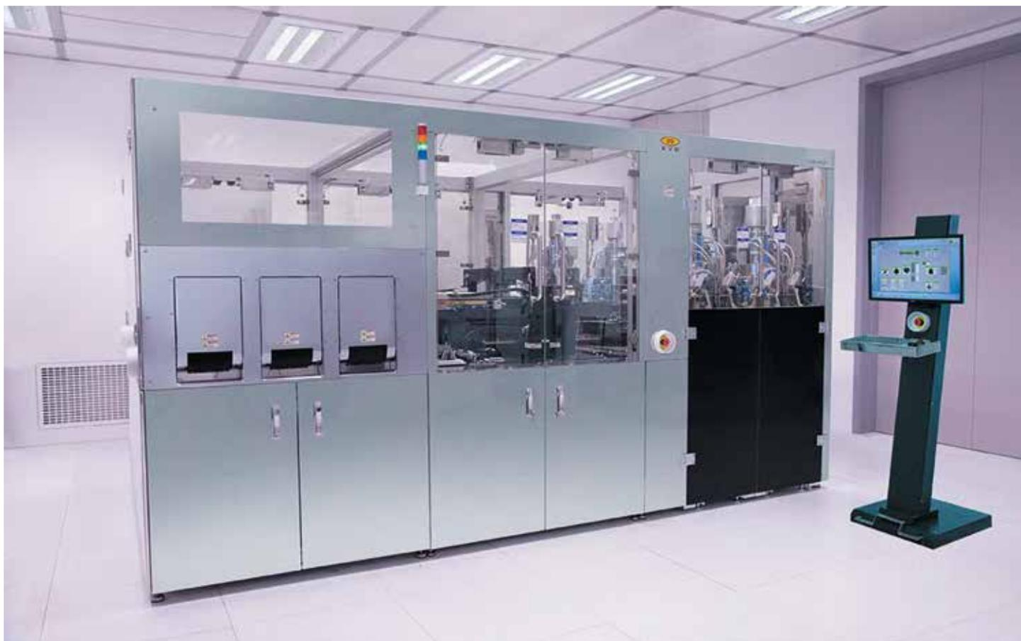
2 Модульная система автоматизированной сварки серии Gemini (конфигурация для реализации технологии прямой сварки кремниевых пластин, оснащенная модулями очистки и плазменной активации)
