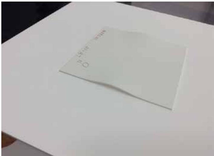
3 Пример деформации LTCC-платы после обжига. Металлизация отсутствует
